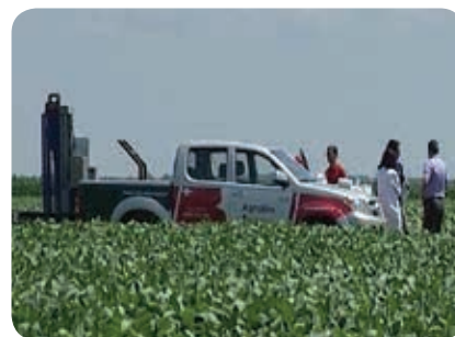
Slika 2. Vozilo sa automatskom opremom za uzorkovanje zemljišta
