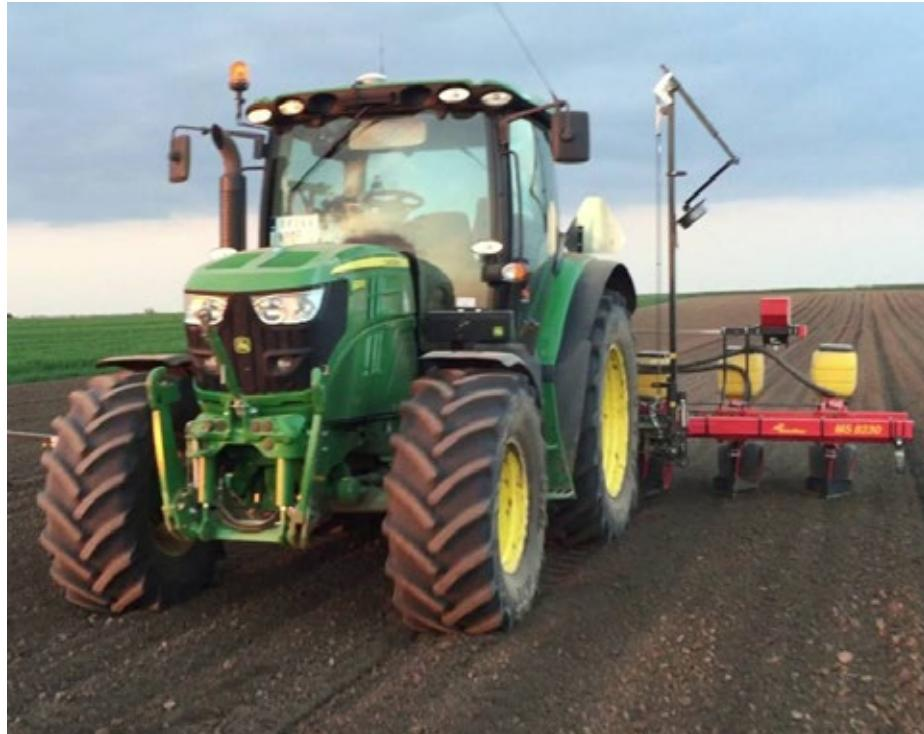
John Deere kontrola sekcija automatski uključuje/isključuje sekcije priključne mašine da bi se smanjilo preklapanje i ekonomično trošio repromaterijal. Kontrola sekcija može da se koristi na sejalicama, prskalicama, rasipačima mineralnog đubriva i ISOBUS kompatibilnim priključnim mašinama. Gen 4 monitori podržavaju rad sa 255 sekcija priključne maštine.
