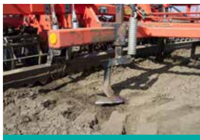
Slika 2. Nazubljena ravnajuća daska i brisač tragova na setvospremaču
