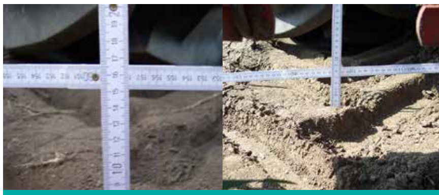
Slika 6. Dubina traga točkova traktora 8 t, levo sa tegovima bez duplih točkova, desno isti traktor bez tegova sa duplim točkovima
