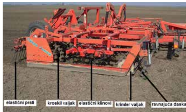
Slika 3. Poželjni raspored radnih organa setvospremača
