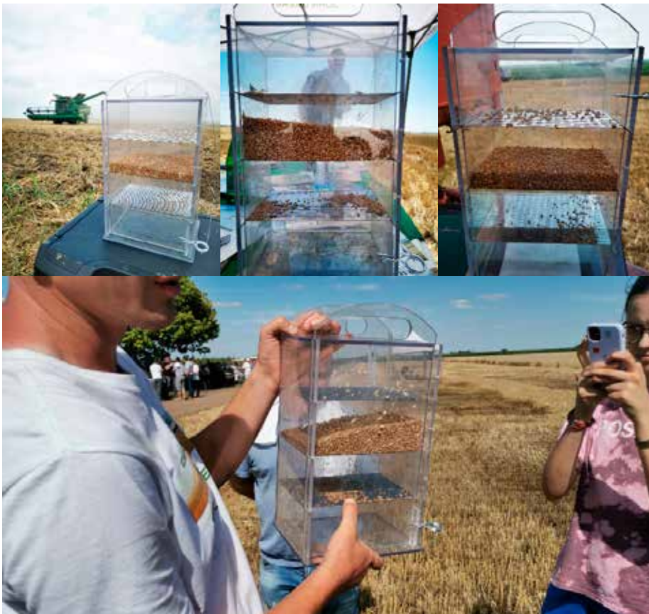
Slika 2, 3, 4 i 5. Zabeležen lom zrna nije prešao 0,3% na lokacijama na kojima je radio kombajn S770i u žetvi pšenice. Lom zrna u selektoru se beleži na najnižem delu kutije. Lokacije: prva slika – „Mitrosrem“ Lačarak, druga slika – gazdinstvo Bigović Novi Kneževac, treća slika – „Agroland“ Novi Bečej, četvrta slika – „Agroplod“ Stapar.
