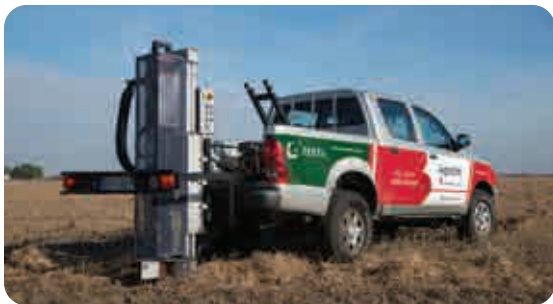
Slika 2. Vozilo sa automatskom opremom za uzorkovanje zemljišta
